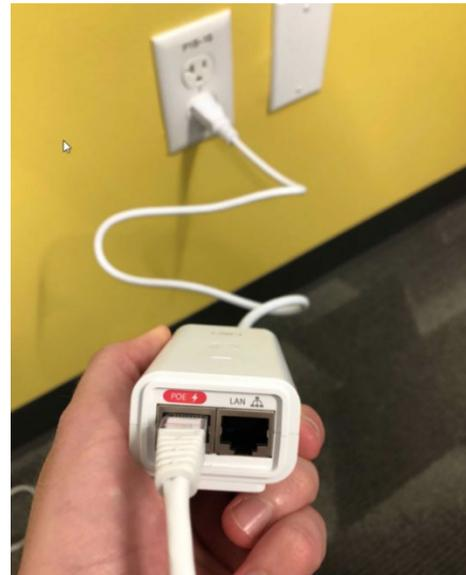
4. Conecte todas las fuentes de alimentación a una salida de “reserva de batería + protección contra sobretensiones” en la UPS **cargada**. Esto incluye las fuentes de alimentación para el NC, el AP, el POS, y el módem.
