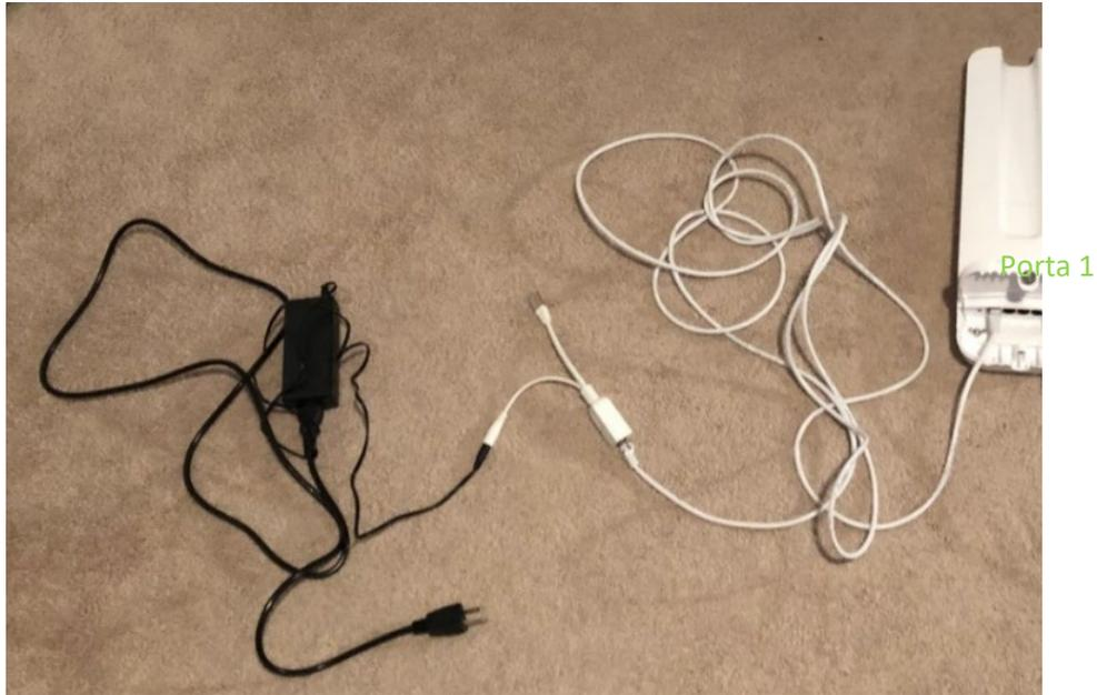
2. Conecte o plugue ethernet do injetor PoE no modem nas portas circuladas abaixo. O modem de dados está à esquerda, o modem surfbeam (usado no Brasil) está à direita.
