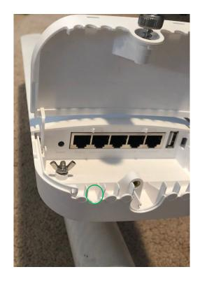
F. Conecte un cable Ethernet al puerto 1 del NC.
