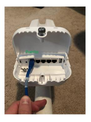
G. Sujete el cable hacia abajo en las aberturas y vuelva a colocar la cubierta inferior. Apriete la tuerca a mano (si tiene).
