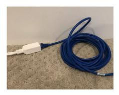
C. Conecte el inyector de PoE al cable de alimentación del NC y el cable de alimentación del NC a la UPS.
