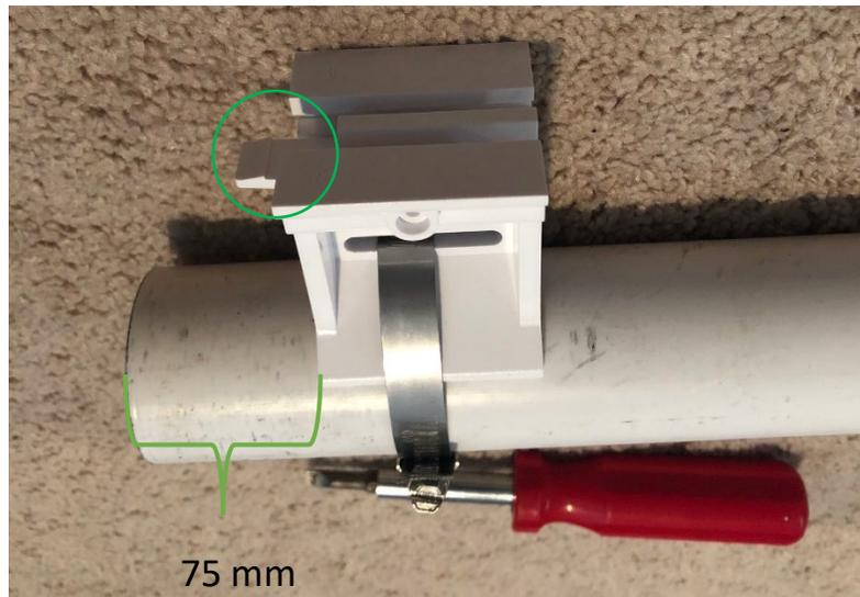
**OBSERVAÇÃO:** Tenha cuidado para não quebrar o plástico do encaixe deslizante apertando a braçadeira metálica com muita força.
