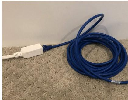
C. Conecte o injetor PoE ao cabo de alimentação do NC e o cabo de alimentação do NC à UPS.
