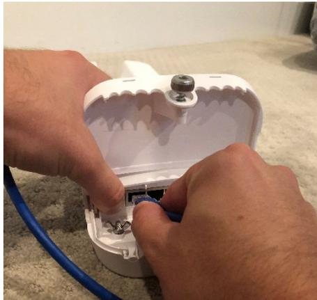
5. Continúe manteniendo pulsado el botón de reinicio hasta que la luz de encendido azul parpadee (esto sucederá 5 segundos después de que el cable Ethernet se conecte al NC).
